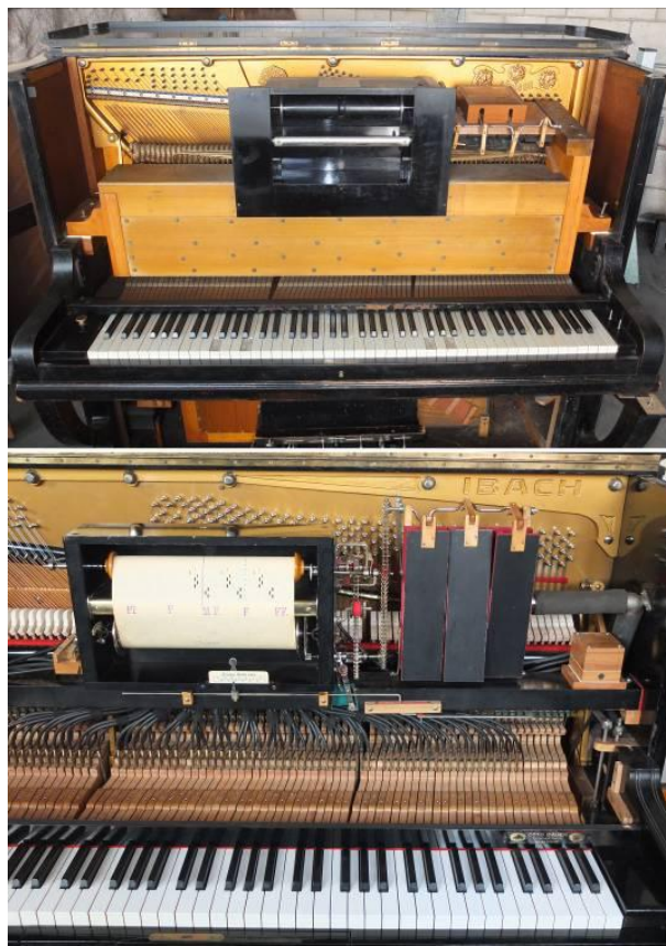
Oben: 73er Phonola mit Obereinbau Unten: 65er Pianola mit Untereinbau
