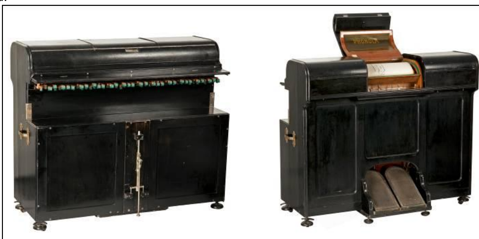
Phonola-Vorsetzer: Pneumatiksteuerung mit Fußpedalen. 73 Tastenhebel, zwei Knöpfe für Pedal und Rücklauf, zwei Schieber für Dynamik (getrennt Diskant/Bass) und Tempo. Musikinstrumentenmuseum der Universität Leipzig Nr. 4058 (Foto: Marion Wenzel)
